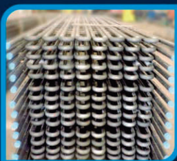
SERPENTINAS DE ECONOMIZADOR
